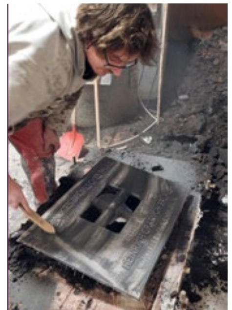
„Auspacken“ des Gusses in der Gießerei Ihle
